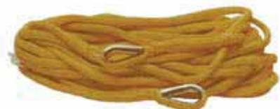
FUNE DI SERVIZIO Composto da treccia in fibra di kevlar senza anima interna.  $\varnothing$  10 mm - lunghezza 20 mt. Forza di rottura: minimo garantito 3400 kg. Carico di rottura sulle asole impalmate e mano: 2700 kg. Alta resistenza al calore.
