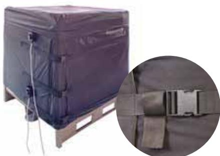
Realizzato con tessuto di ottima qualità ed estremamente resistente, il riscaldatore incorpora, per ognuno dei 2 settori riscaldanti una resistenza di 1000W controllata da un termostato a capillare 0-90°C. È fornito con un semplice ed efficace sistema di fissaggio con cinghie di trazione per una ottimale installazione. Dotato di isolamento in teflon/poliestere. Fornito con 3 mt di cavo per alimentazione.
