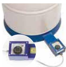
Realizzato con 2 lastre di metallo spessore 2 mm, estremamente rigide. Il riscaldamento è prodotto per mezzo di una resistenza piatta in silicone con potenza 900 W con una perfetta distribuzione del calore su tutta la superficie. Isolata con 50mm di lana di roccia ad alta densità garantisce un ottimo isolamento alla superficie d'appoggio del riscaldatore. Classe di isolamento I - Termostato 0-150°C - Fornito con 2 mt di cavo per alimentazione corazzato - di semplice installazione.
