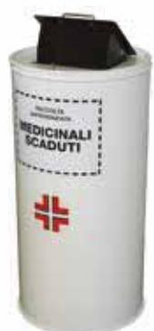
Forma cilindrica verticale, fondo piano. Acciaio zincato anticorrosione per esposizione permanente agli agenti atmosferici, con verniciatura esterna con polveri essiccate al forno. Colore standard bianco, lavabile e disinfettabile. Coperchio apribile con serratura a chiave. Bocchetta superiore di immissione auto scaricante antiprelievo colore nero, con maniglia cromata. Scritta adesiva di identificazione del rifiuto (croce rossa sanitaria), applicata sul contenitore.
