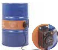
Realizzato con isolamento in silicone di ottima qualità ed estremamente resistente, il riscaldatore incorpora un termostato a capillare 0-120°C che permette un ottimo controllo della temperatura. È fornito con sistema di fissaggio a molle per una facile installazione e con 2 mt di cavo per alimentazione. Resistente all'umidità ed agenti atmosferici.
