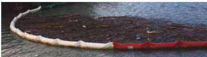
La barriera antinquinamento permanente è utilizzata per l'impiego fisso o temporaneo sia in acque protette che in mare aperto, ove è richiesta una grande riserva di spinta. Viene fornita in moduli standard da 10 mt. di colore giallo.
