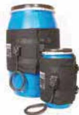
Realizzato con tessuto di ottima qualità ed estremamente resistente, in doppio isolamento il riscaldatore incorpora un termostato a capillare 0-90°C che permette un ottimo controllo della temperatura. È fornito con un semplice ed efficace sistema di fissaggio con cinghie di trazione per una ottimale installazione. Dotato di isolamento in teflon/poliestere. Fornito con 3 mt di cavo per alimentazione.
