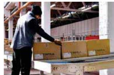
**Peso e volume vengono verificati** per controllare la conformità rispetto ai dati teorici e riportati sulla etichetta. In caso di difformità, il cartone viene scartato e ricontrollato.
