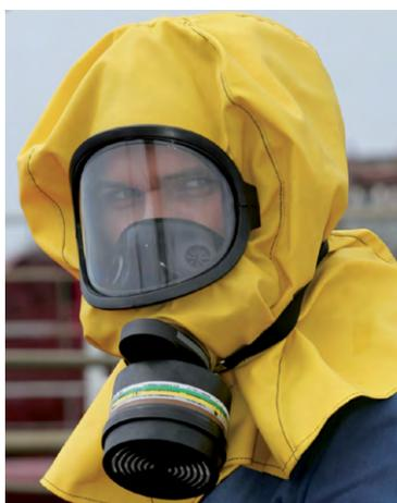
**Maschera antigas** a pieno facciale con corpo in **EPDM**, visore in policarbonato, raccordo filettato EN 148/1, con una valvola di inspirazione, membrana fonica, due valvole di inspirazione della semimaschera interna e due valvole di espirazione fissate alla maschera con fascette metalliche del tipo a scatto. Cappuccio in tessuto sintetico spalmato in PVC, applicato alla maschera nella zona perimetrale del visore e nella zona perimetrale del gruppo raccordo di inspirazione.
