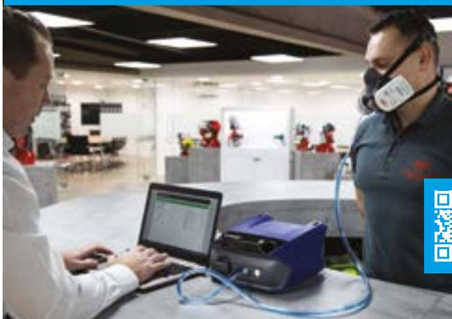
L'adattatore portacount/AccuFIT per il fit test quantitativo per la gamma Force™ consente di collegare le semimaschere Force™ al dispositivo per eseguire il test.
