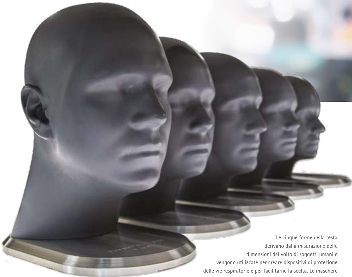
Le cinque forme della testa derivano dalla misurazione delle dimensioni del volto di soggetti umani e vengono utilizzate per creare dispositivi di protezione delle vie respiratorie e per facilitarne la scelta. Le maschere sono progettate per adattarsi a dimensioni specifiche e sono testate sui visi corrispondenti.
